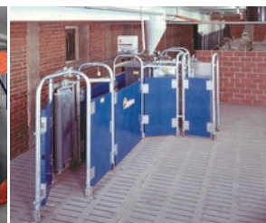
Maquinas de chip para gestación en grupo CallMatic 2
